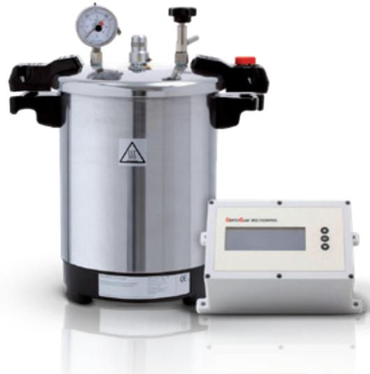
Die Sterilisationskammer besteht aus hochwertigem 3103-Aluminium. In den Boden der Kammer ist eine Heizung eingepresst, dabei liegen die Heizelemente jedoch nicht direkt im Wasser und können somit nicht verkalken. Dies verlängert die Lebensdauer der Autoklaven. Auch sonst sind unsere Autoklaven äußerst wartungsarm.
