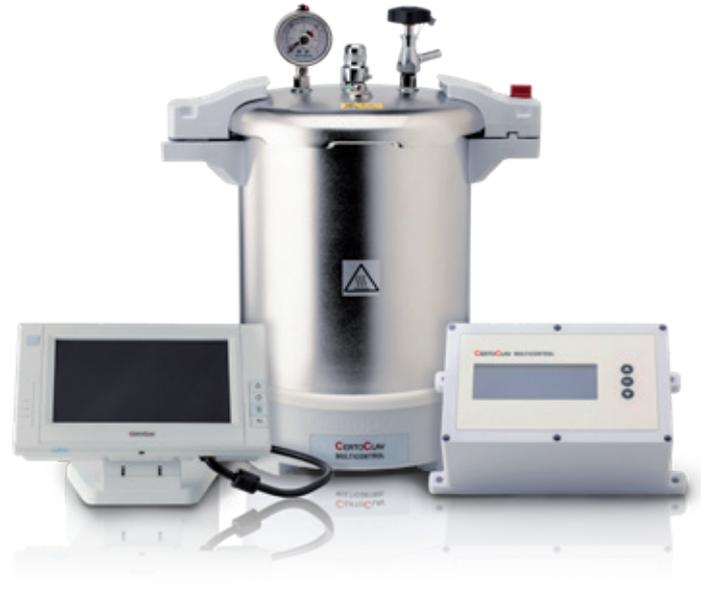
Die Sterilisationskammer besteht aus korrosionsbeständigem, elektrolytiertem Edelstahl (316L). Das macht sie extrem robust. Am Boden der Kammer ist eine Heizung angeschraubt, dabei liegen die Heizelemente jedoch nicht direkt im Wasser und können somit nicht verkalken. Dies verlängert die Lebensdauer der Autoklaven. Auch sonst sind unsere Autoklaven äußerst wartungsarm.
