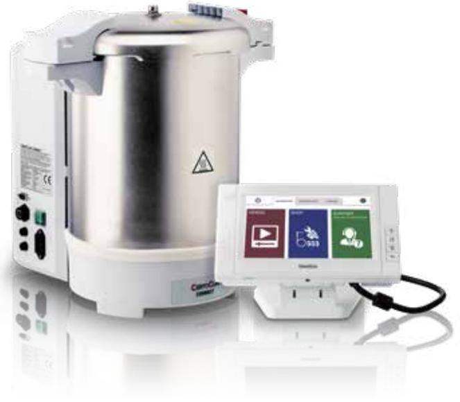
Die Sterilisationskammer besteht aus korrosionsbeständigem, elektrolytiertem Edelstahl (316L). Das macht sie extrem robust. Am Boden der Kammer ist eine Heizung angeschraubt, dabei liegen die Heizelemente jedoch nicht direkt im Wasser und können somit nicht verkalken. Dies verlängert die Lebensdauer der Autoklaven.
