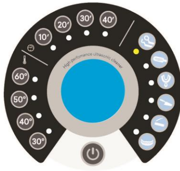
Hellblaues fixes Licht. Ultraschall in Betrieb.
