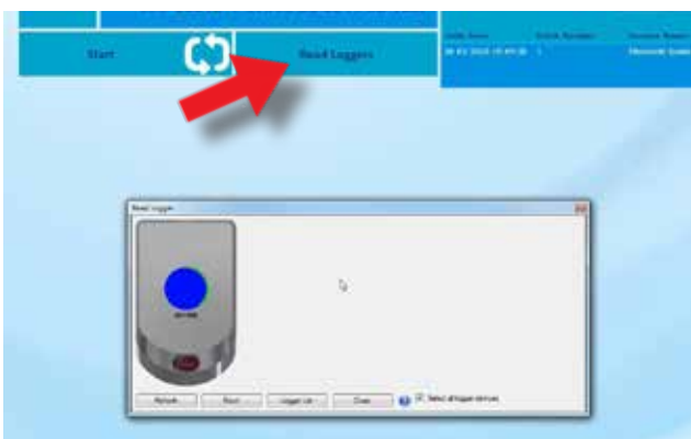
Wenn das Testprogramm abgeschlossen ist, stellen Sie den SteriSense wieder auf die Lesestation, um die Daten auszulesen.
