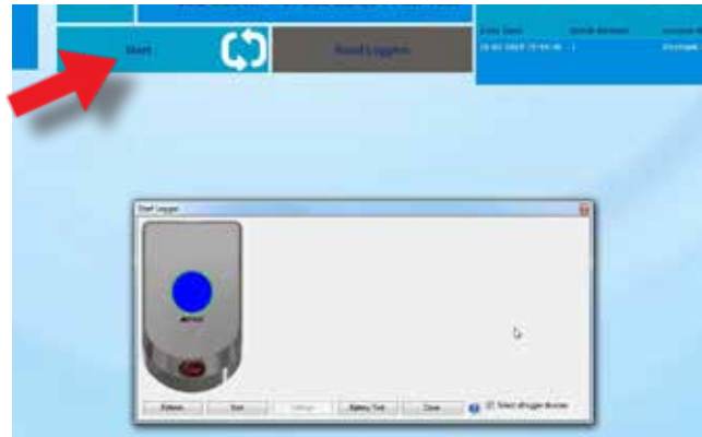
Drücken Sie „Start“, um die Messung zu beginnen und platzieren den SteriSense im Dampfsterilisator.
