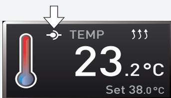
Wenn sich das Gerät im Fernbedienungsbetrieb befindet, ist dies am Symbol
