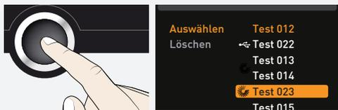
4. Auswahl mit der Bestätigungstaste bestätigen. Das Programm wird nun geladen, erkennbar an der Ladeanzeige.
