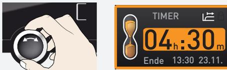
2. Drehknopf drehen, bis die gewünschte Laufzeit – in diesem Beispiel 4 Stunden 30 Minuten – angezeigt wird. Darunter wird in kleinem Format die berechnete voraussichtliche Endzeit angezeigt.
