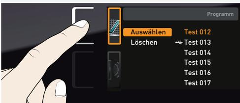
1. Programmanzeige aktivieren. Dazu die Aktivierungstaste links neben der Anzeige Prog drücken. Die Anzeige wird vergrößert und der Eintrag Auswählen automatisch markiert. Rechts werden die aktivierbaren Programme angezeigt. Das derzeit zur Ausführung bereitstehende Programm – in diesem Beispiel Test 012 – ist orange markiert.
