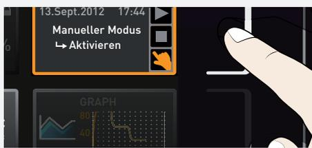
1. Aktivierungstaste rechts neben der Statusanzeige drücken. Es wird automatisch der aktuelle Betriebszustand markiert, in diesem Beispiel manueller Modus (👉).
