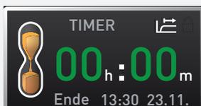
Wenn der Timer abgelaufen ist, zeigt die Anzeige 00h:00m. Alle Funktionen (Heizung usw.) werden abgeschaltet. Es ertönt zusätzlich ein akustisches Signal, das durch Drücken der Bestätigungstaste abgeschaltet werden kann.
