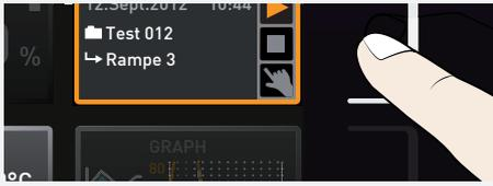
1. Aktivierungstaste rechts neben der Statusanzeige drücken. Die Statusanzeige wird automatisch markiert.
