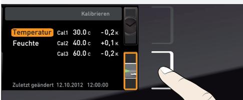
1. Aktivierungstaste rechts neben der Anzeige KALIB drücken. Die Anzeige wird vergrößert und automatisch die Temperaturjustierung markiert.
