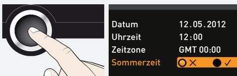
6. Auswahl mit der Bestätigungstaste bestätigen. Es werden die Einstellmöglichkeiten markiert.
