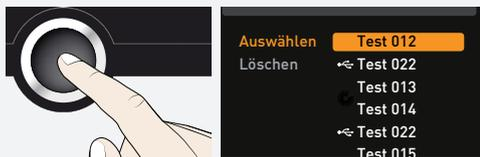
2. Funktion Auswählen durch Drücken der Bestätigungstaste aufrufen. Es werden alle verfügbaren Programme angezeigt, auch diejenigen, die sich auf dem USB-Datenträger befinden (erkennbar am USB-Symbol). Das derzeit zur Ausführung bereitstehende Programm ist orange hinterlegt.
