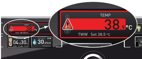
Wenn eine Temperaturüberwachung angesprochen hat, wird dies in der Temperaturanzeige angezeigt: durch die rot hinterlegte Isttemperatur und ein Alarmsymbol
