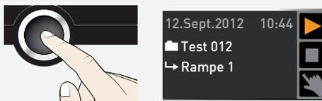
3. Zum Starten des Programms Bestätigungstaste drücken. Das Programm wird ausgeführt. In der Anzeige sind zu sehen:
