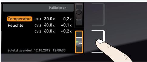
1. Aktivierungstaste rechts neben der Anzeige KALIB drücken. Die Anzeige wird vergrößert und automatisch die Temperaturjustierung markiert.
