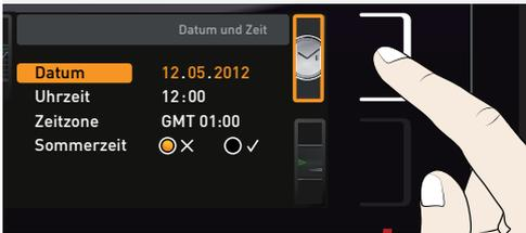
1. Zeiteinstellung aktivieren. Dazu die Aktivierungstaste rechts neben der Anzeige ZEIT drücken. Die Anzeige wird vergrößert und automatisch die erste Einstellmöglichkeit (Datum) markiert.
