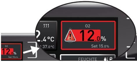
Wenn die Feuchteüberwachung angesprochen hat, wird dies in der Feuchteanzeige angezeigt: durch die rot hinterlegte Istfeuchte und ein Alarmsymbol . Ist im Menümodus der Signalton bei Alarm aktiviert (Signalton, Kapitel 7.7, erkennbar am Lautsprechersymbol ), wird der Alarm zusätzlich durch einen Intervallton signalisiert. Informationen, was in diesem Fall zu tun ist, finden Sie im Kapitel 6.
