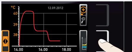
1. Aktivierungstaste rechts neben der Anzeige GRAPH drücken. Die Anzeige wird vergrößert und der Temperaturverlauf dargestellt.
