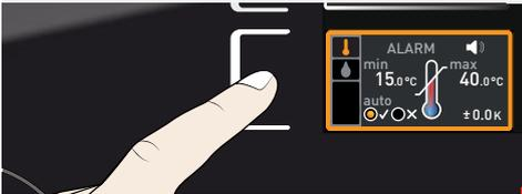
1. Aktivierungstaste links neben der Anzeige ALARM drücken. Es wird automatisch die Einstellung der Temperaturüberwachung aktiviert.
