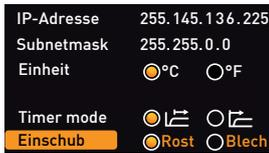
Hier muss eingestellt werden, welche Art Einschub (Gitterrost oder Blech) verwendet wird. Die Auswahl Blech ermöglicht die Anpassung der Regelfunktion an das unterschiedliche Strömungsverhalten im Innenraum bei der Verwendung von optionalen Einschieblechen anstatt der im Standardlieferumfang enthaltenen Gitterroste.
