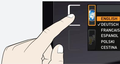
1. Gewünschte Einstellung (in diesem Beispiel Sprache) aktivieren. Dazu die Aktivierungstaste links bzw. rechts neben der entsprechenden Anzeige drücken. Die aktivierte Anzeige wird vergrößert.
