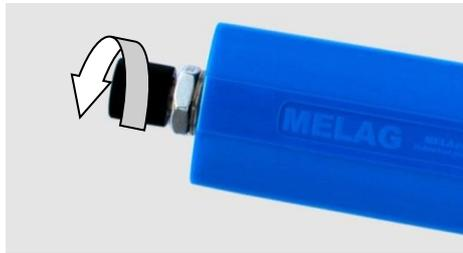
1. Schrauben Sie die Verschlusskappe des Helix-Prüfkörpers ab.
