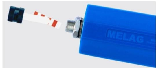
2. Stecken Sie einen Indikatorstreifen in den Schlitz des Kunststoffhalters der Verschlusskappe.
