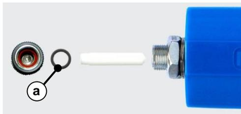
Nach 250 Tests sollte die Dichtung (a) in der Verschlusskappe gewechselt werden. Diese liegt jedem Nachfüllpack der Indikator-Teststreifen bei.
