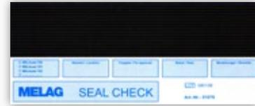
Für die regelmäßige Funktionsprüfung wird der MELAG seal check empfohlen. Mit Hilfe eines Indikatorstreifens wird geprüft, ob die Qualitätsmerkmale einer einwandfreien Schweißnaht erfüllt sind. Für die jährliche professionelle Überprüfung der in der Praxis hergestellten Schweißnähte des MELAseal® Pro bietet MELAG eine Siegelnahtfestigkeitsprüfung an.
