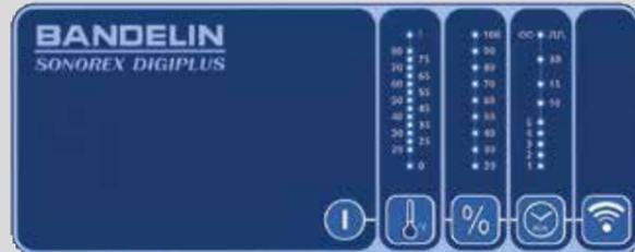
Zusätzlich zu den am SONOREX DIGITEC wählbaren Parametern lässt sich die Ultraschalleistung in 10%-Schritten einstellen. Dies ist beispielsweise für eine schonende Behandlung von besonders empfindlichen Oberflächen, Glasflächen, Beschichtungen oder unstrukturierten Siliziumsubstraten (Wafer) der Fall.
