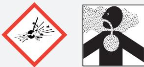
Beim Beschicken des Geräts mit ungeeignetem Beschickungsgut können giftige oder explosionsfähige Dämpfe oder Gase entstehen. Dadurch kann das Gerät explodieren und Menschen können schwer verletzt oder vergiftet werden. Das Gerät darf nur mit Materialien/ Prüfgut beschickt werden, die beim Erhitzen keine giftigen oder explosionsfähigen Dämpfe bilden.
